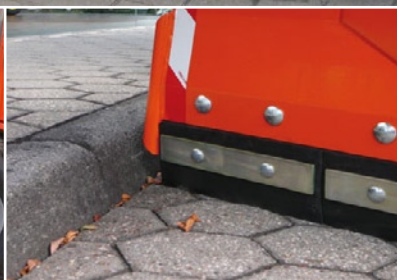
Randabweiser und Federklappensystem schützen vor Beschädigungen
