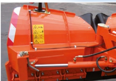
Die hydraulische Seitenverstellung sorgt für den gewünschten Winkel
