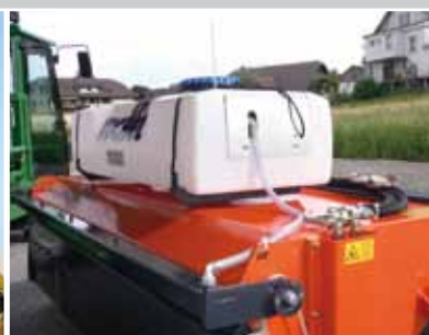
Wassersprüheinrichtung mit 100/200 Liter Wassertank
