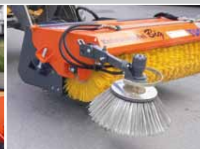
Seitenkehrbesen mit Federelement (50% PP / 50% Stahl)
