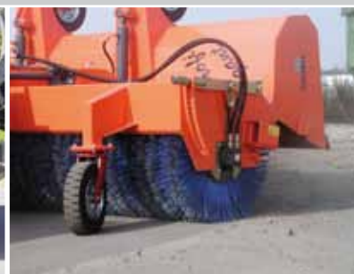
einfache Bürstennachstellung über Rasthebelsystem
