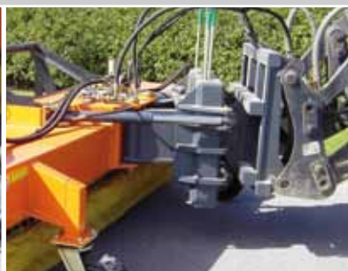
optimale Boden Anpassung durch robusten 3D-Niveausgleich
