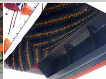
V-förmig angeordnete Spezial-Kehrwalze, für Fein- u. Grobschmutz
