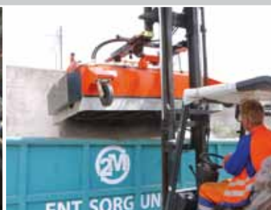
hydraulische Entleerung des Sammelbehälters, serienmäßig
