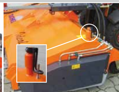
Handkurbel zum Einstellen der pendelnd aufgehängten Kehrwalze
