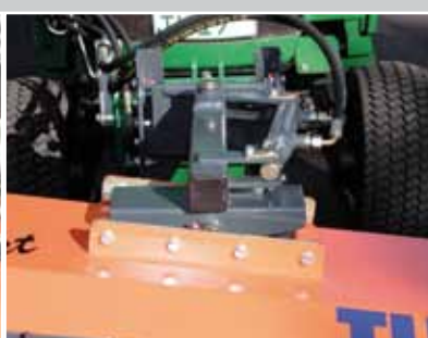
doppelter Niveaueingleich mit hydraulischer Seitenverstellung
