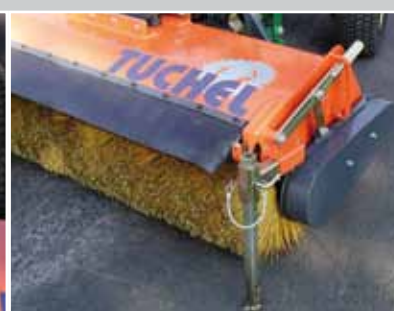
Rasthebelsystem und Abstellstütze
