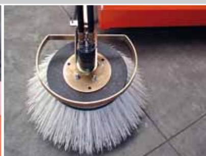
Seitenkehrbesen hydraulisch angetrieben
