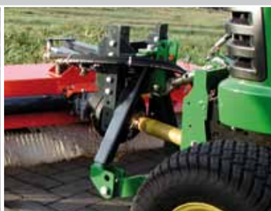
mechanischer Antrieb für Drehzahlen von 540 bis 2100 /min
