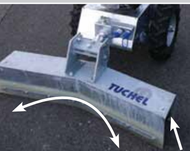
Doppellippenschieber inkl. Niveaueingleich mit Randabweiser als Rolle
